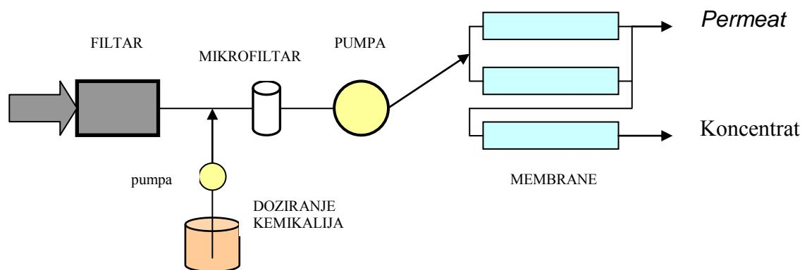
Osnovna shema uređaja za pripremu vode s nanofiltracijom
